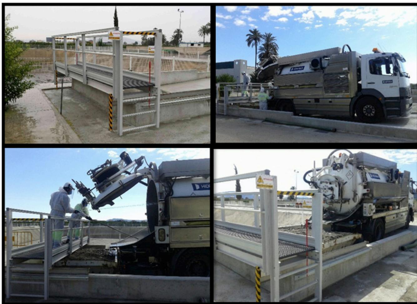
*Limpieza de cuba de camión de alcantarillado en punto de descarga seguro.*
